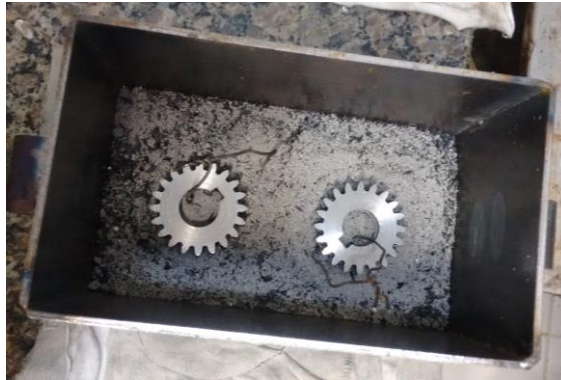
Figura 16 - Engrenagens colocadas sobre a primeira camada da mistura no fundo da caixa de cementação.
