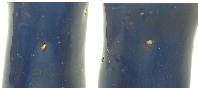
Figura 34 – Detalhes dos descolamentos do esmalte azul sobre massa com GR
