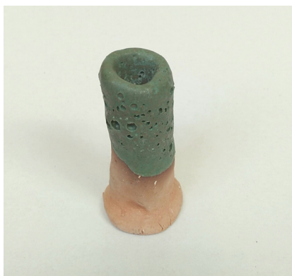
Figura 32 – Esmalte L2 com coloração C e 5% de GR, com defeito de borbulhamento
