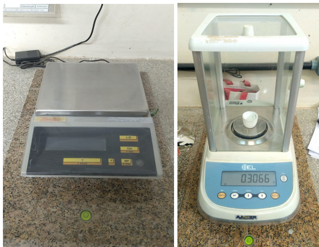
Figura 18 – Balança com 0,01 g de precisão (esq.) e balança com 0,0001 g de precisão (dir.)
