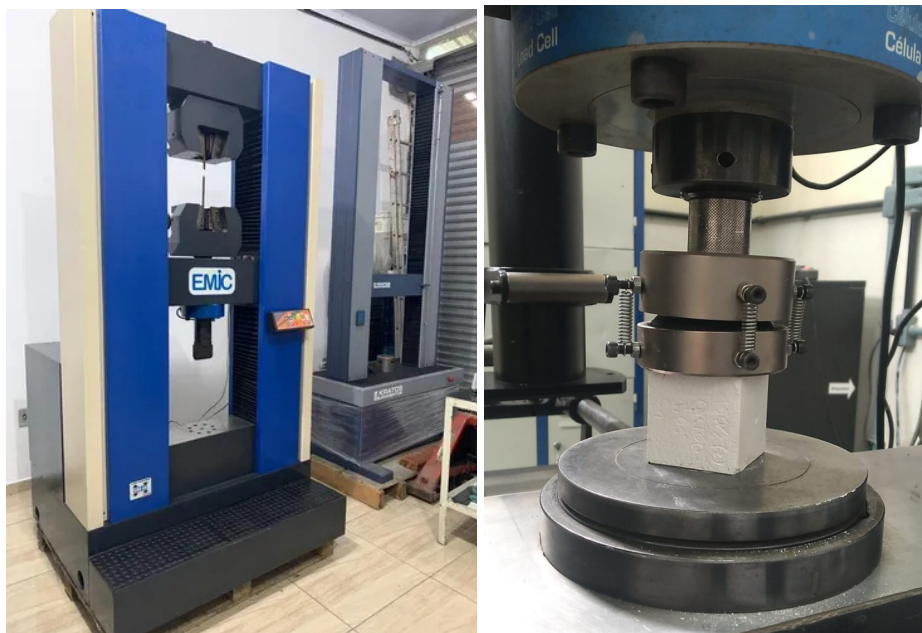
Figura 11 – Máquina universal de ensaio (esq.) e teste de resistência à compressão (dir.)
