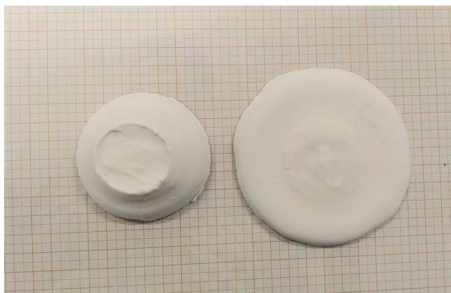
Figura 8 – Espalhamento de amostras no teste de mini-slump
