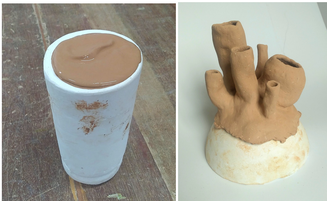
Figura 24 – Produção do cilindro por meio do molde cilíndrico com GR (esq.) e estrutura da peça demonstrativa sobre molde semiesférico com GR (dir.)
