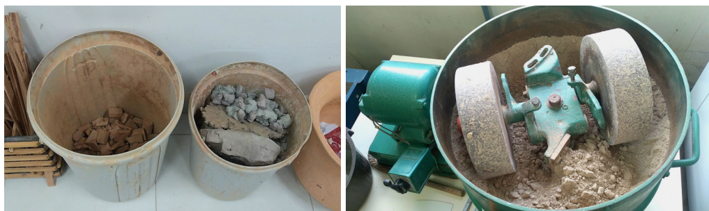
Figura 12 – Argilas disponíveis para reciclagem (esq.) e sua moagem (dir.)
