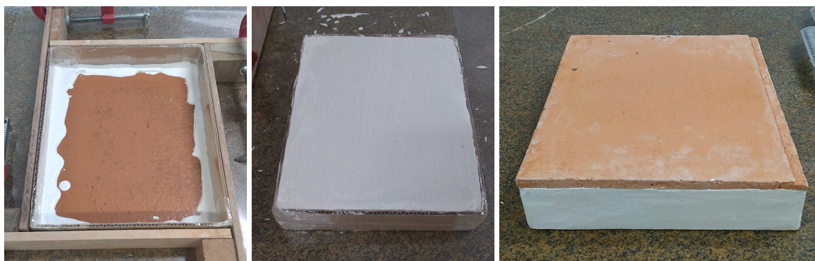
Figura 22 – Molde sendo preenchido (esq.), molde preenchido (centro) e protótipo pronto (dir.)
