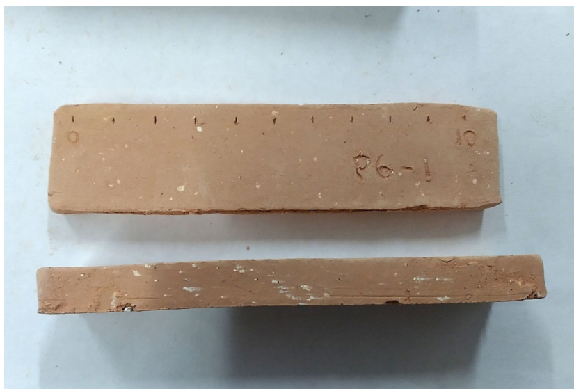
Figura 26 – Pontos brancos de GR na superfície da massa cerâmica
