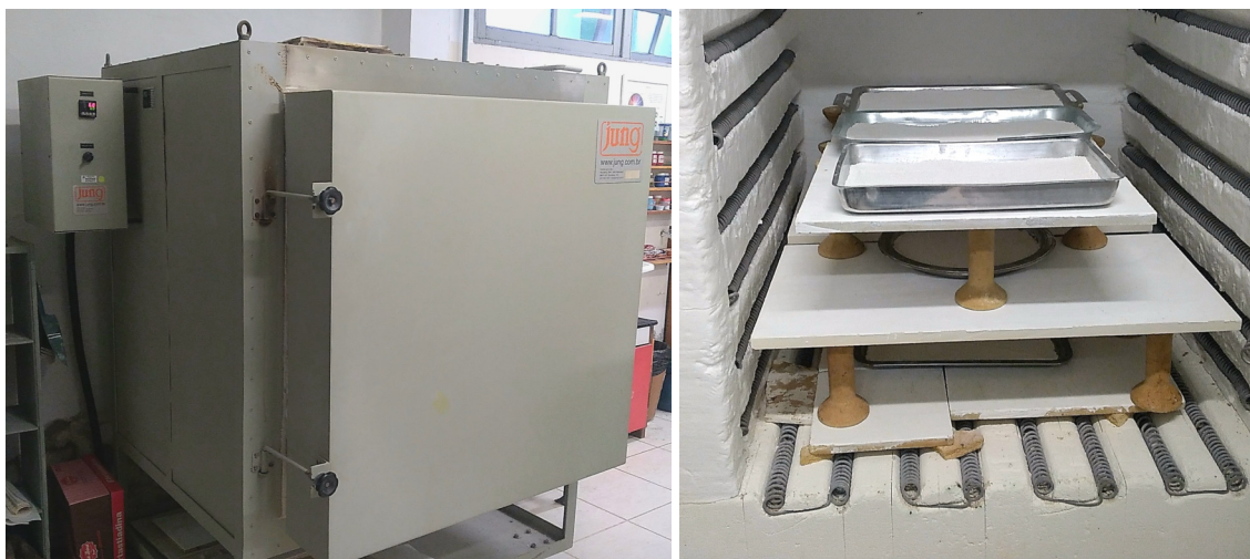
Figura 6 – Forno Jung (esq.) e gesso disposto em formas para a calcinação (dir.)
