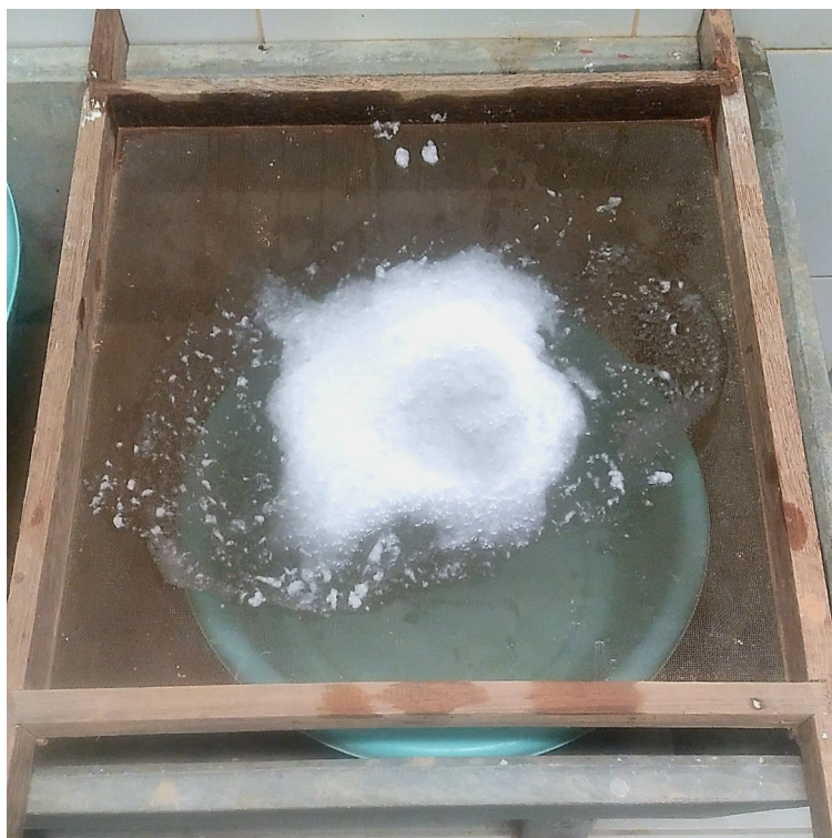
Figura 13 – Coagem da polpa de celulose
