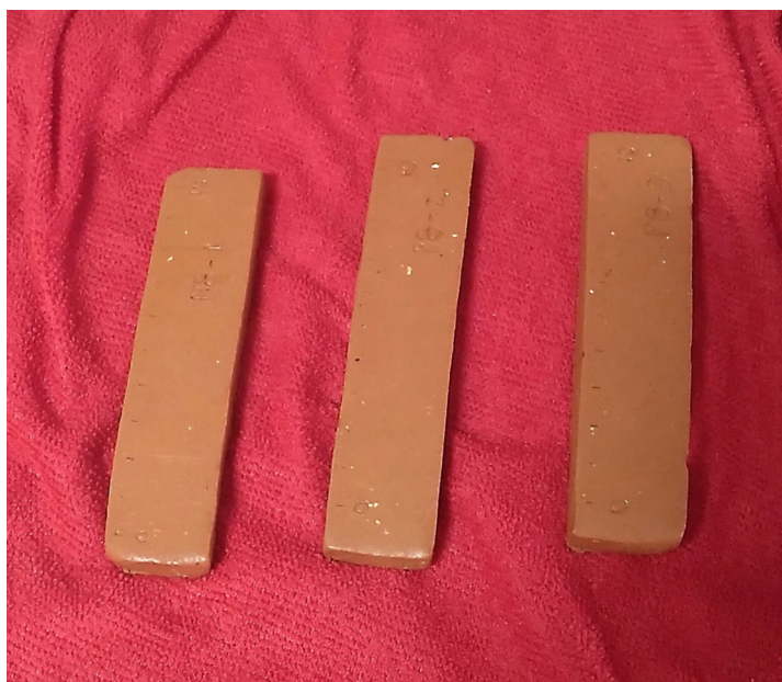
Figura 16 – CPs cerâmicos impregnados de água e secos superficialmente com um pano de microfibra molhado
