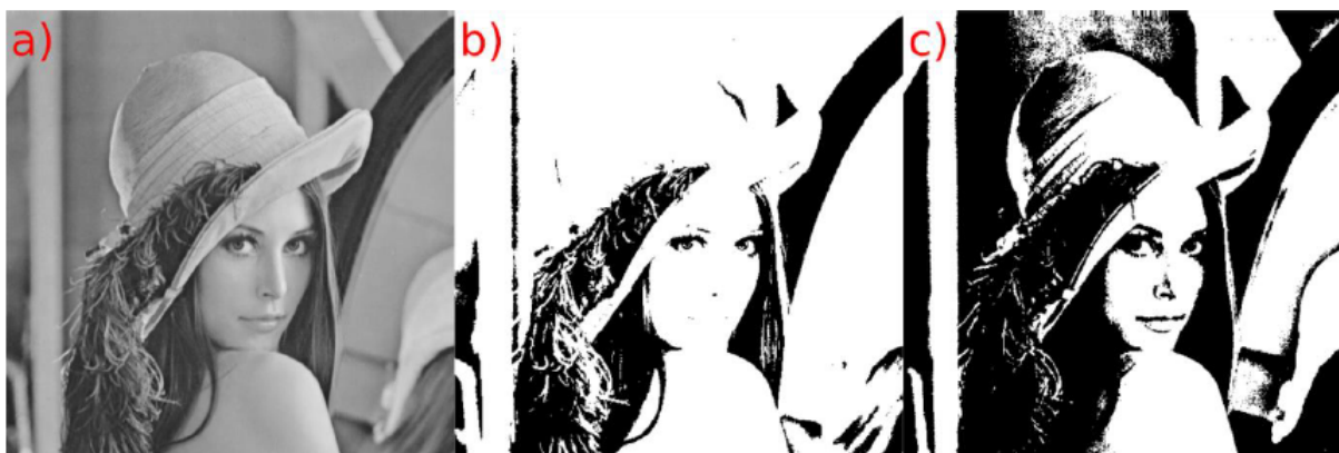
Figura 8 – Etapas de Limiarização aplicadas a uma imagem
