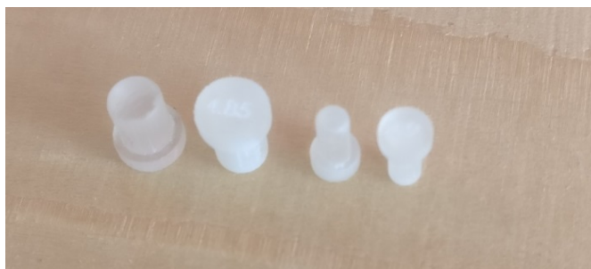
Figura 36 – Resultado da impressão dos rebites.
