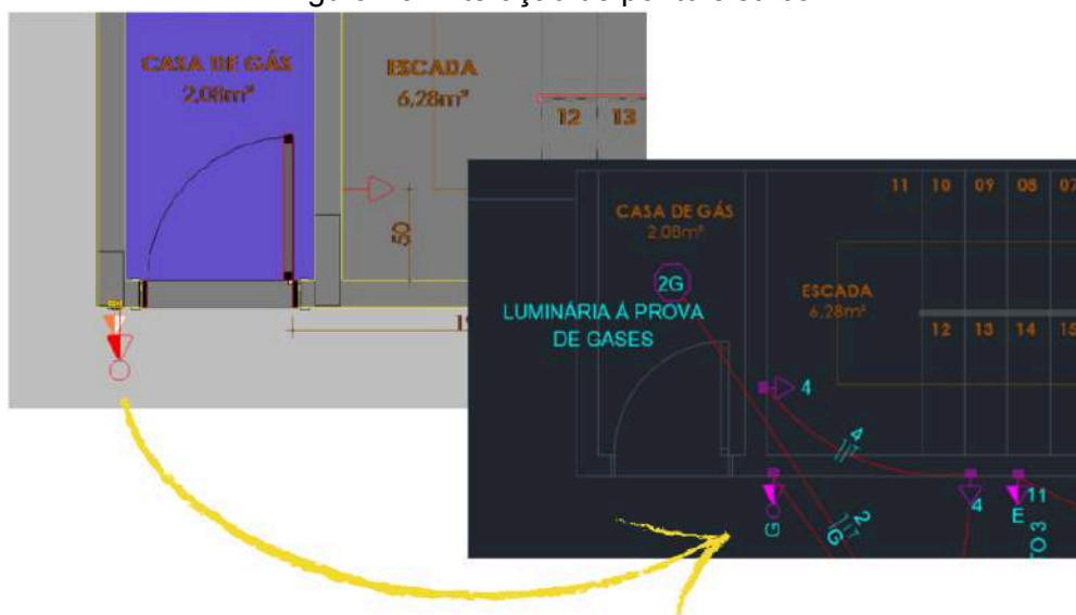
Figura 10: Alteração de ponto elétrico
