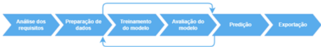
Figura 16 – Etapas do processo de Aprendizado de Máquina Centrado no Ser Humano (HCML)
