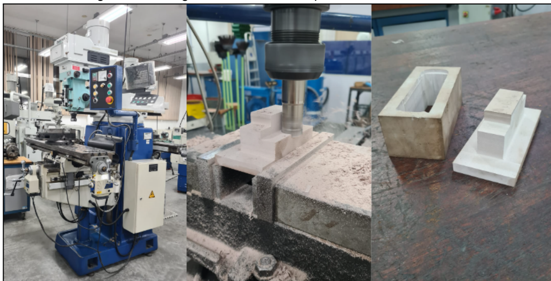
Figura 15 - Fotografia do molde do dispositivo usinado em resina
