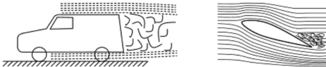
Figura 16 - Separação da camada limite em um veículo rombudo e um aerofólio [2].
