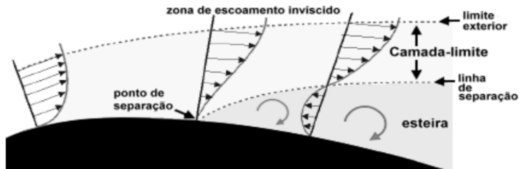
Figura 15 - Esquema de separação da camada limite [10].
