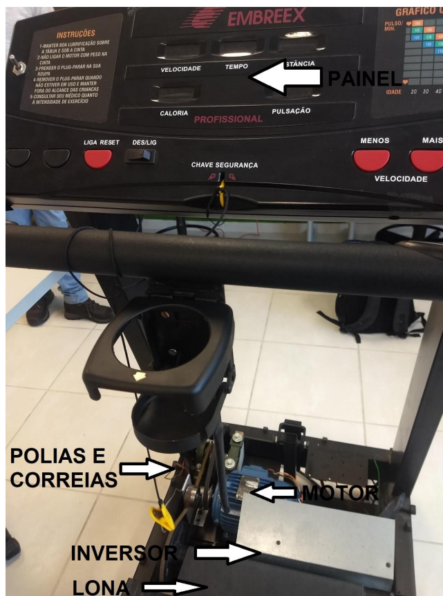
Figura 4 - Componentes da Esteira
