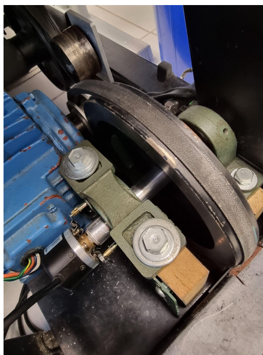
Figura 24 - Adaptação Mecânica para acoplar o encoder
