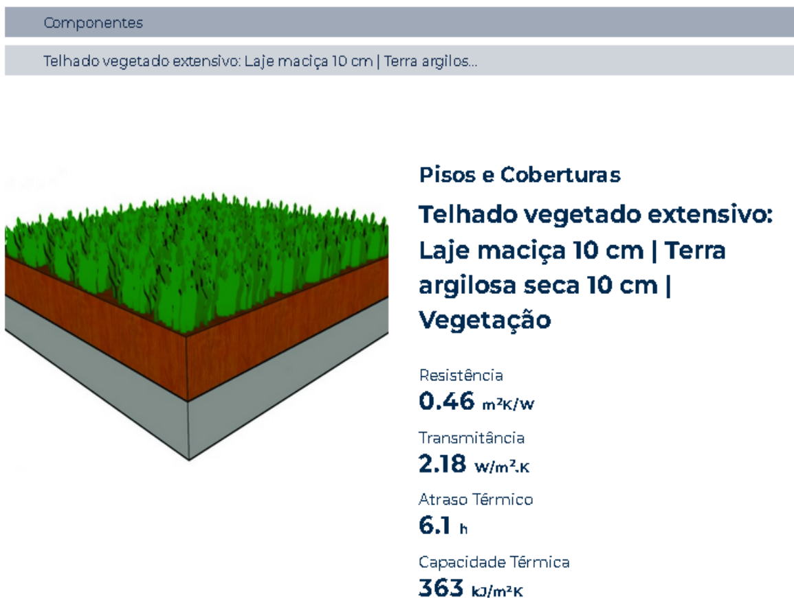
Figura 6 - Telhado vegetado e suas propriedades térmicas
