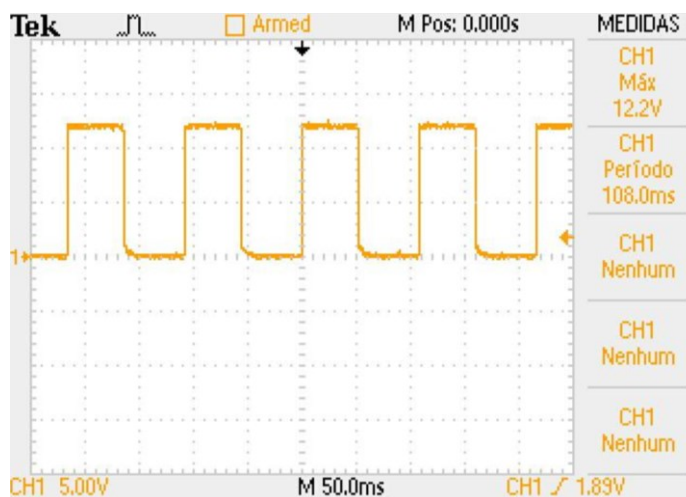
Figura 67 - Forma de onda da saída de sinal de pulso 12 V.
