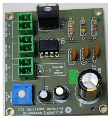
Figura 62 - Placa de controle para esteiras tracionadas montada.
