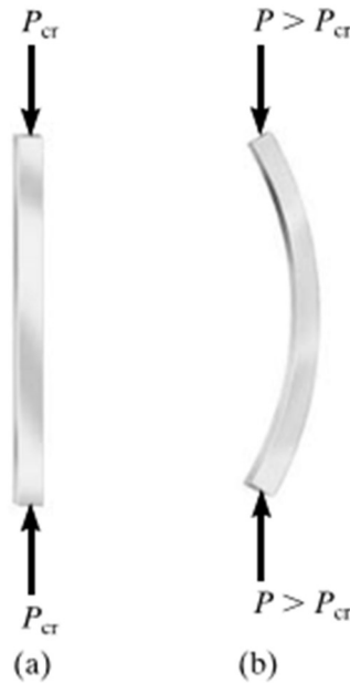
Figura 12 - Vigas em compressão
