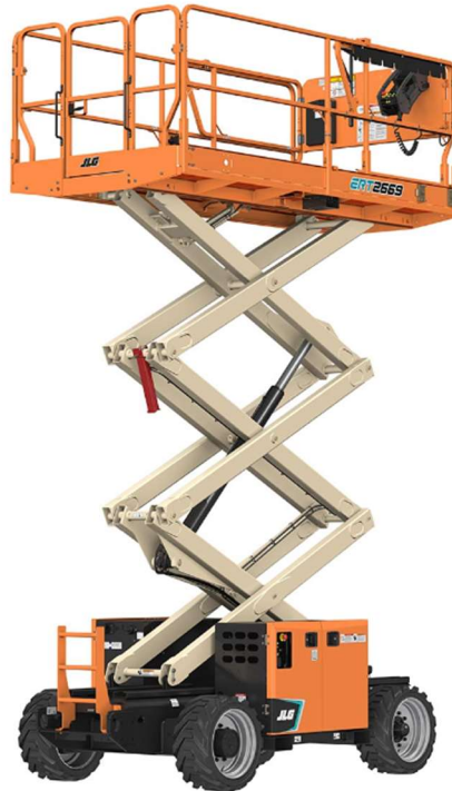
Figura 34 - Elevador de cargas pantográfico
