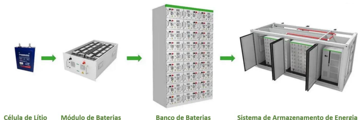
Figura 4 – Partes dos sistemas de baterias
