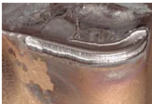
Figura 9 – Desgaste de flanco
