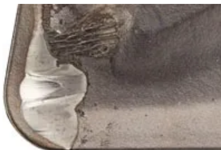
Figura 11 – Desgaste de cratera
