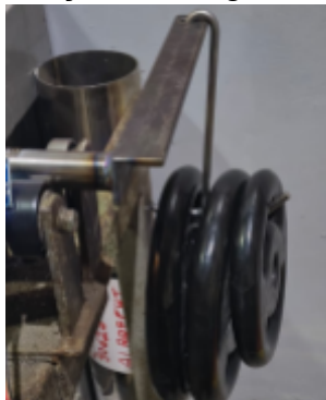
Imagem 7 – aplicação da carga no corpo de prova.
