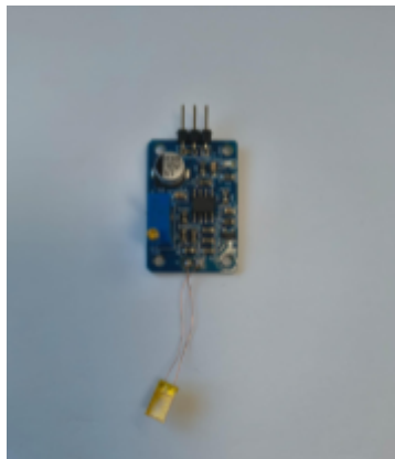
Imagem 4 – módulo sensor strain gauge BF350
