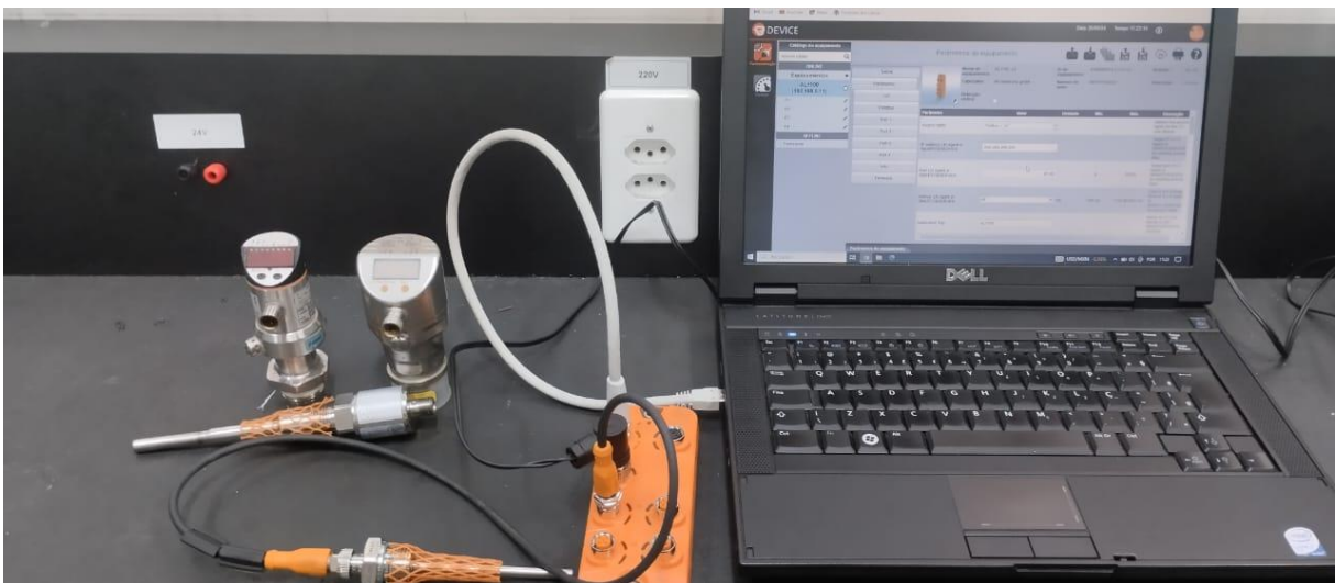
Figura 4. Comunicação dos transmissores por rede IO LINK.
