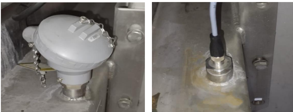
Figura 2: PT100 IP55 (à esquerda) e PT100 IP69K (à direita).
