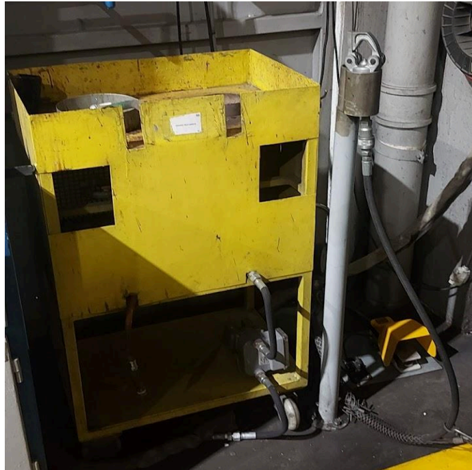
Figura 6- Estanhador e prensa cabo hidráulico.
