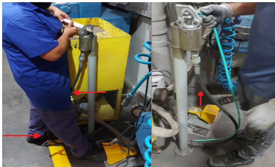
Figura 14 - Mangueira em contato com o operador (A); Mangueira sem proteção (B).
