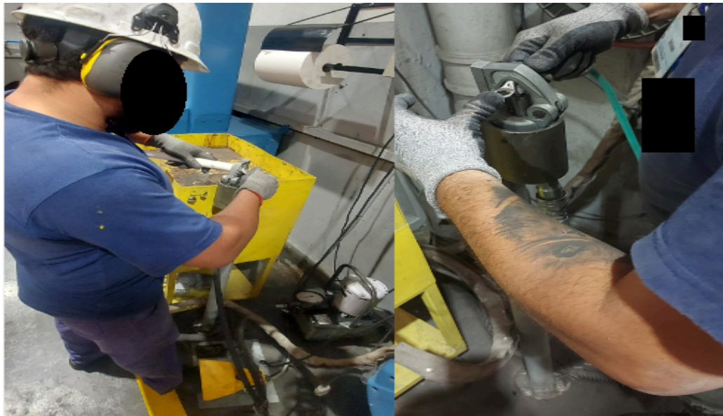
Figura 11 - Operador prensando cabo 120 mm 2 (A); Operador prensando cabo 25 mm 2 (B).
