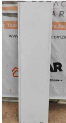
Figura 114 – Placas de GRC armazenadas
