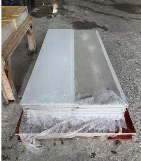
Figura 38 – Placas de GRC finalizadas e armazenadas
