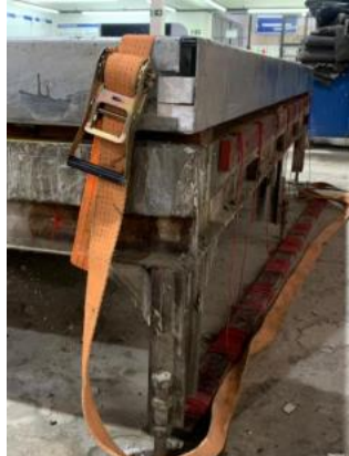
Figura 50 – Travamento da estrutura
