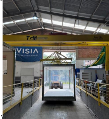
Figura 70 – Movimentação interna dos módulos com ponte rolante: (a) deslocamento do módulo pela ponte rolante; (b) módulo aguardando remoção para armazenamento
