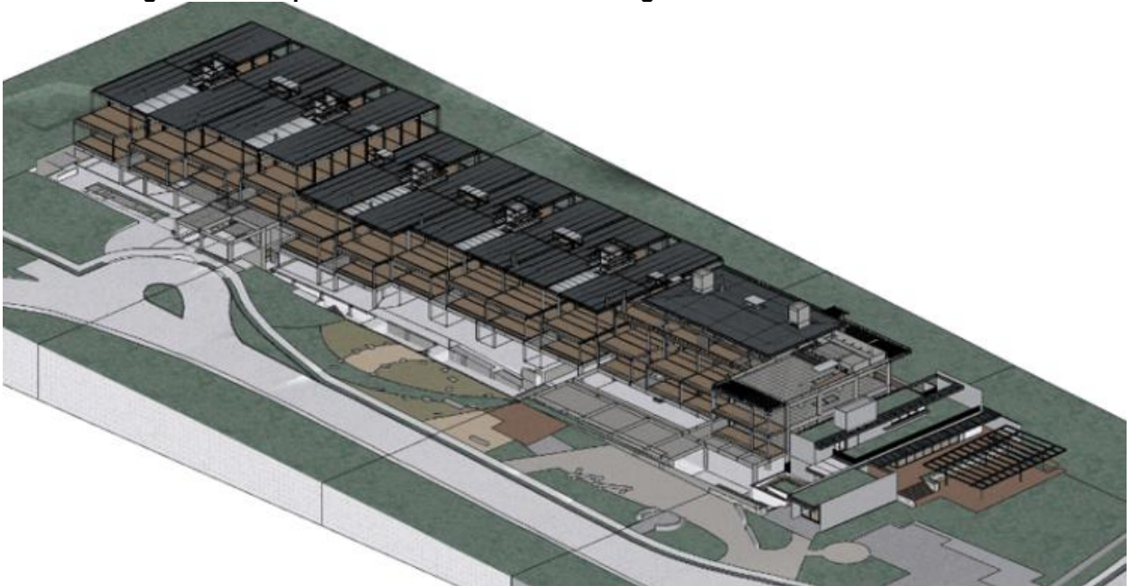
Figura 91 – Etapa 3: Posicionamento e montagem dos módulos estruturais
