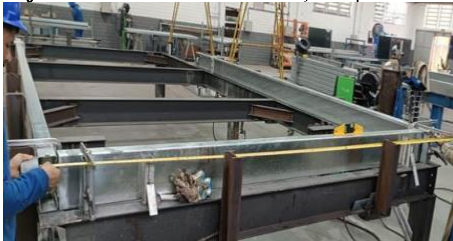
Figura 57 – Conferência dimensional e marcação dos pontos de solda
