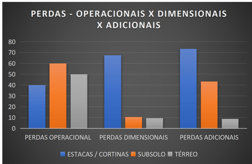
Figura 10 - Perdas de concreto (m 3 ) – Projetado x Realizado – Etapa 02 – Objeto de estudo 01.
