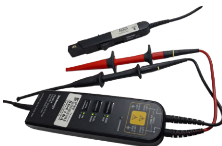
Figura 36 – Sonda diferencial de tensão e sonda de corrente utilizadas para obtenção dos resultados experimentais no protótipo
