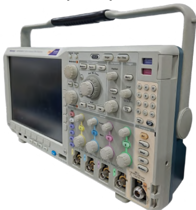
Figura 35 – Osciloscópio MDO4054B-3 utilizado para obtenção dos resultados experimentais no protótipo
