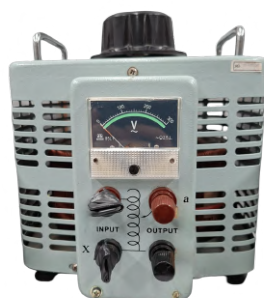
Figura 41 – Variador de tensão CA monofásico utilizado para regular a tensão de alimentação utilizado para obtenção dos resultados experimentais de compatibilidade eletromagnética do protótipo
