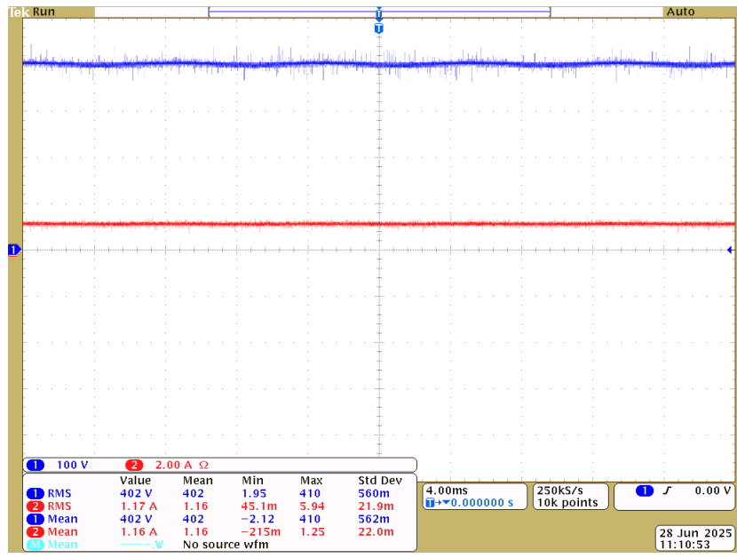
Figura 49 – Forma de onda da tensão e corrente de saída do retificador PFC pra 450 W e 220 V
