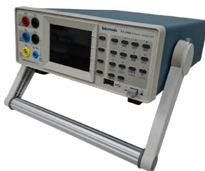
Figura 39 – Analisador de potência PA1000 utilizado para obtenção dos resultados experimentais do protótipo
