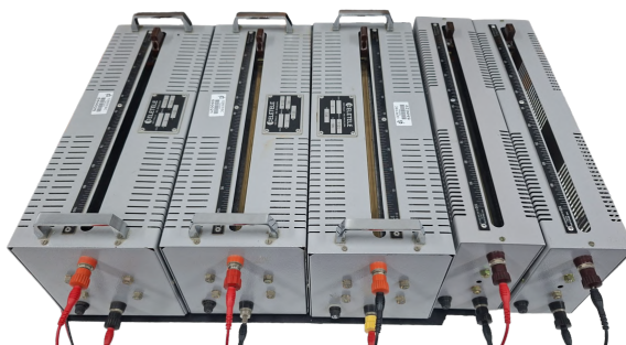
Figura 37 – Conjunto de cargas resistivas variáveis utilizadas para obtenção de resultados experimentais do protótipo
