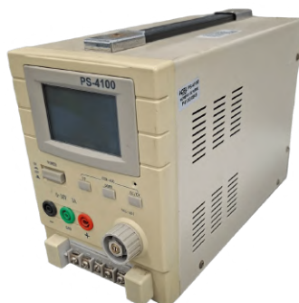
Figura 34 – Fonte de tensão CC PS4100 utilizada para alimentação inicial dos circuitos integrados do protótipo
