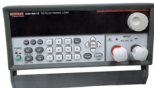
Figura 38 – Carga eletrônica 2380-500-15 utilizada para obtenção de resultados experimentais do protótipo
