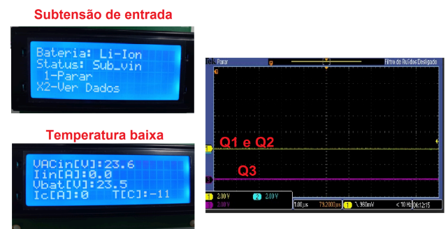
Fig. 11: Chaveamento em falha (2 V / divisão).
