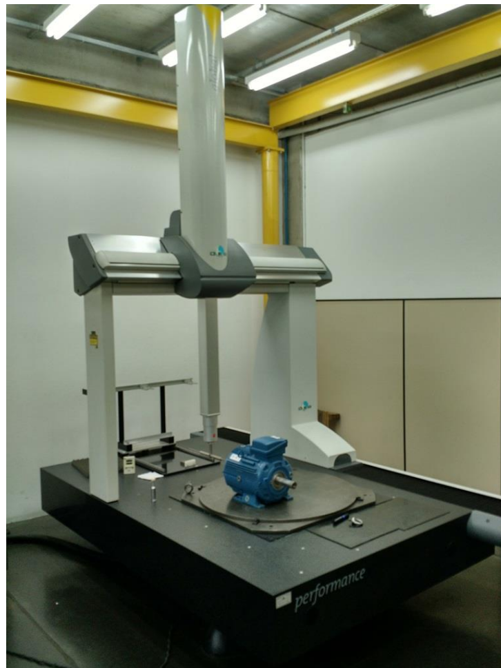
Figura 5 – Medição dos motores na Tridimensional
