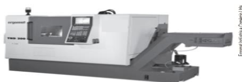
Figura 2 - Torno CNC Ergomet TND 200 com comando Fanuc
