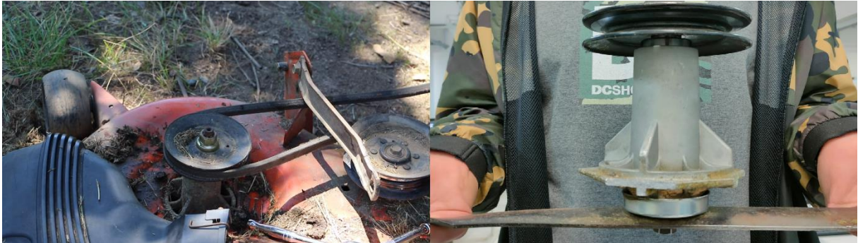
Figura 17 - Localização carcaça de mandril no trator huskvarna TS 142
