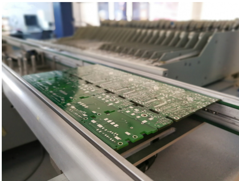
Figura 2 – Montagem de PCIs na Produza
