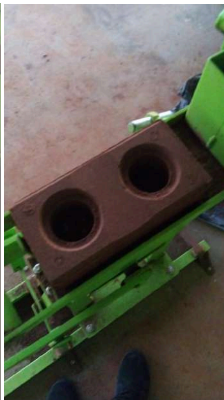
Figura 46: Tijolo na prensa traço AG
