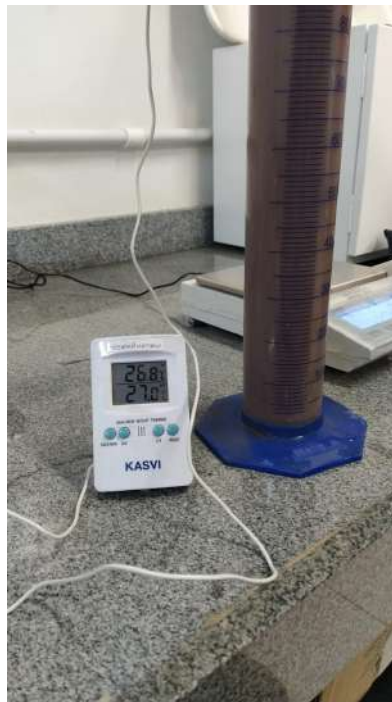
Figura 17: Medição temperatura da proveta 1lt
