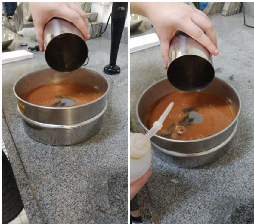
Figura 16: Passando a solução na peneira de 45 micrômetros e lavagem do recipiente para evitar perda de amostra
