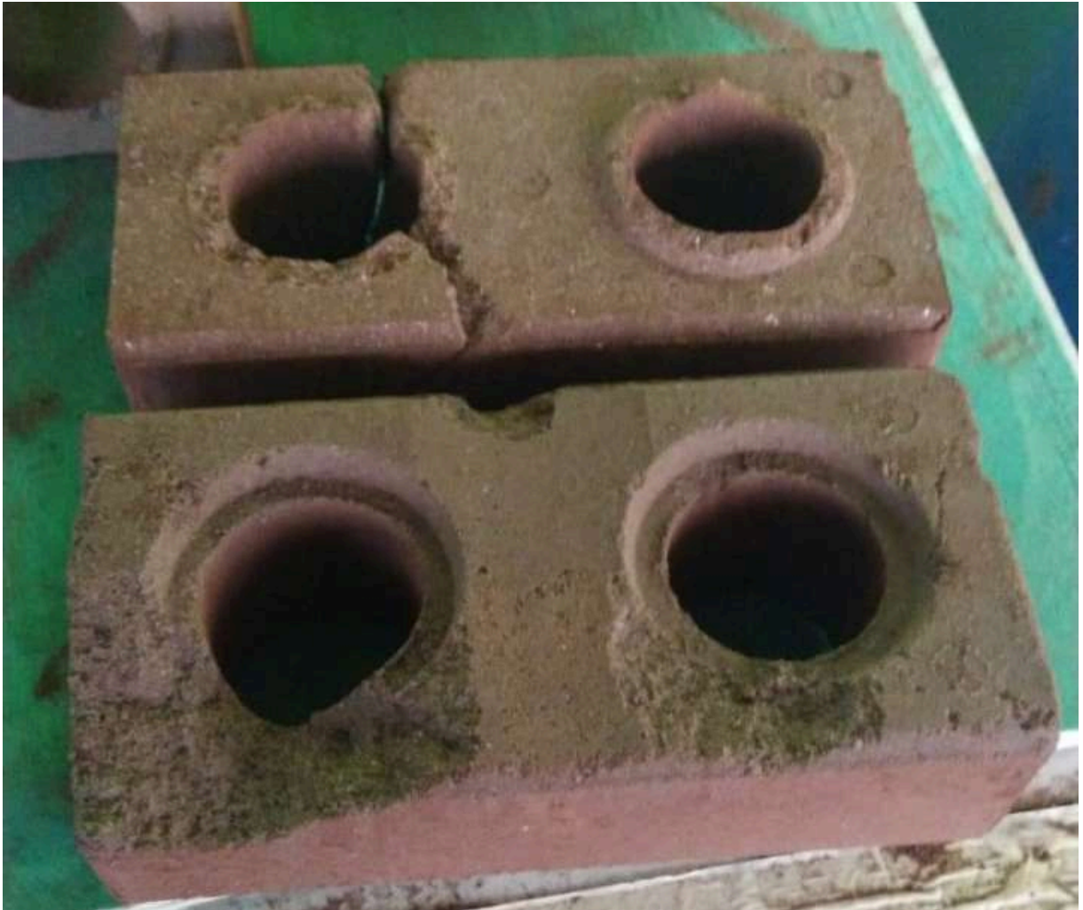
Figura 44: Detalhe, defeitos bloco
