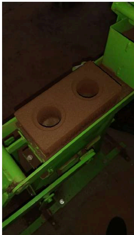
Figura 45: Tijolo na prensa traço AF
