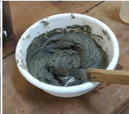
Figura 56: Pasta de cimento
