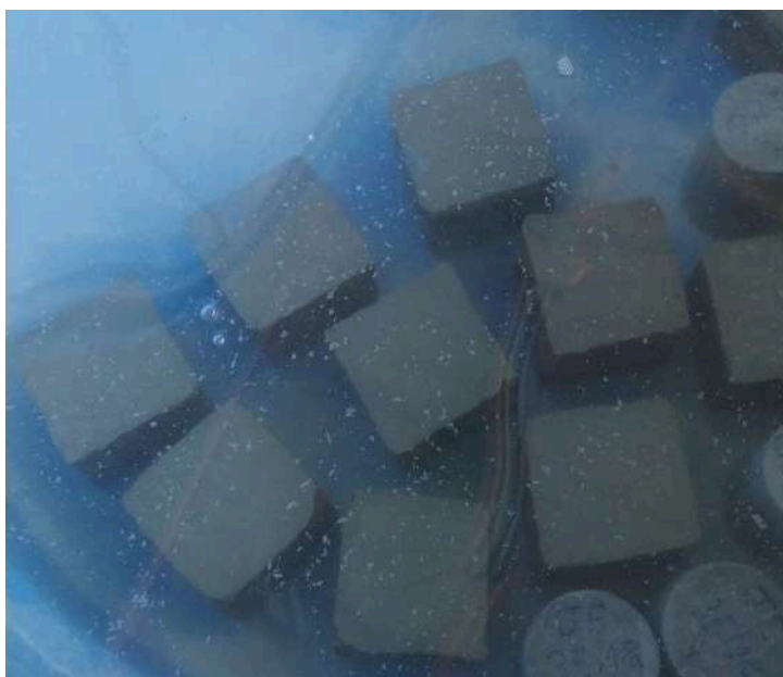
Figura 59: Corpos de prova submerso para o rompimento
