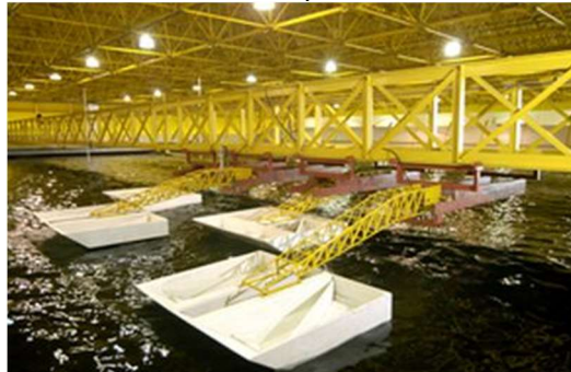
Figura 22 - Modelo teste no Tanque Oceânico da COPPE/UFRJ
