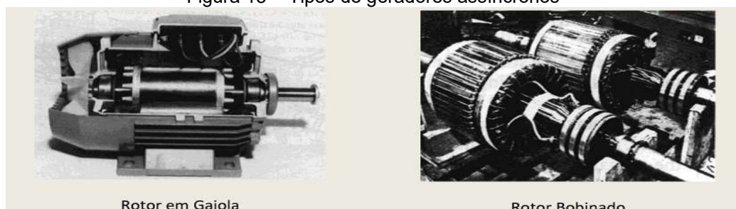
Figura 13 - Tipos de geradores assíncronos
