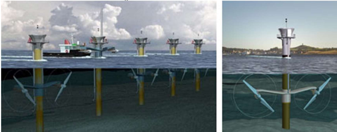
Figura 19 – Turbina de Maré
