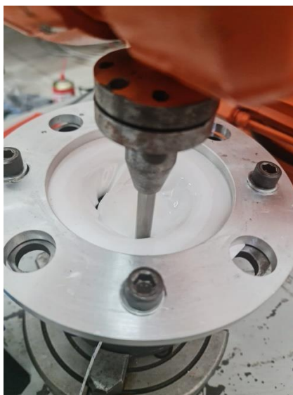
Figura 22 – Aparecimento da primeira Fratura durante a conformação
