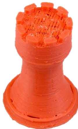
Figura 42: Camada superiores insuficientes.
