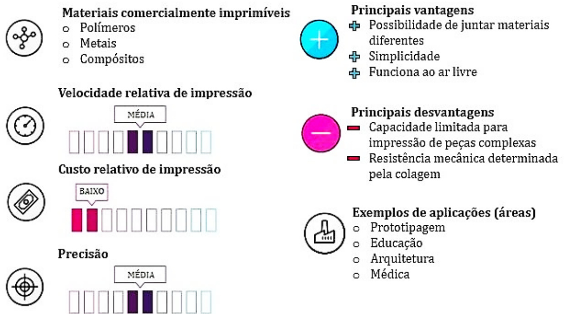
Figura 36: Características da deposição com energia direcionada.
