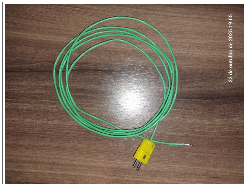
Figura 16 – Termopar tipo K utilizado
