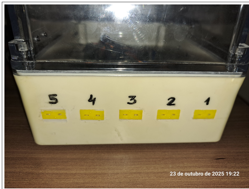
Figura 18 – Conectores fixados à carcaça do protótipo
