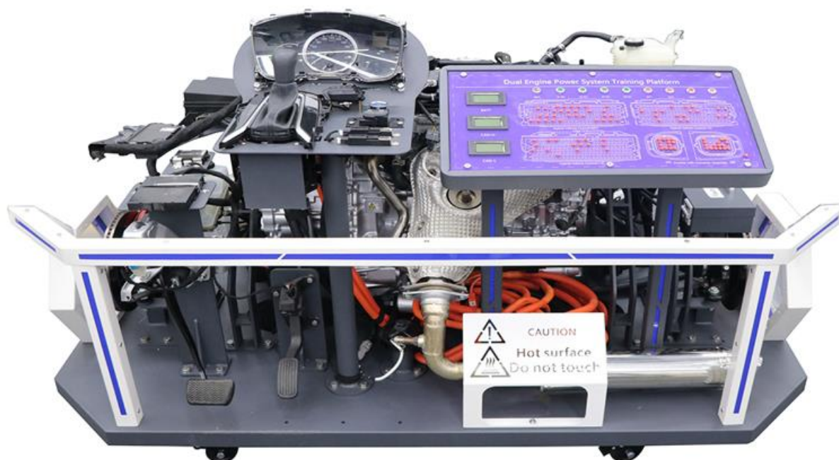
Figura 26 - Ilustração do Powertrain da bancada Toyota Corolla híbrido Beifang
