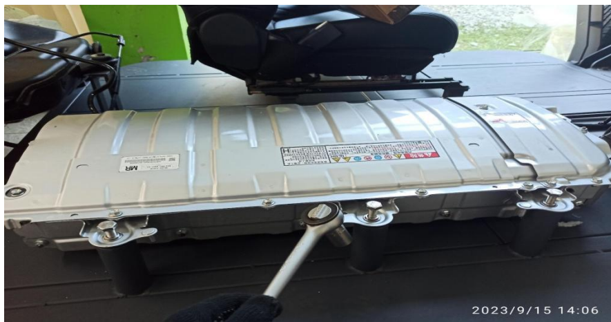
Figura 14 – Bateria de tração do Corolla na bancada do chassi
