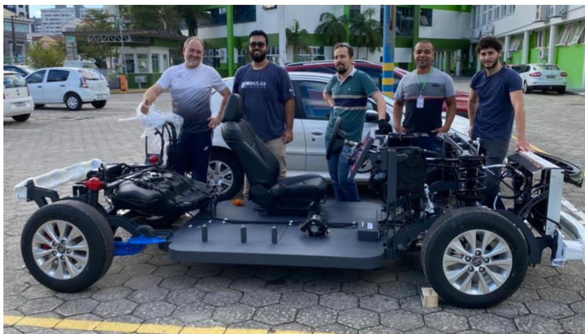
Figura 25 - Ilustração da plataforma estrutural do veículo Toyota híbrido Beifang
