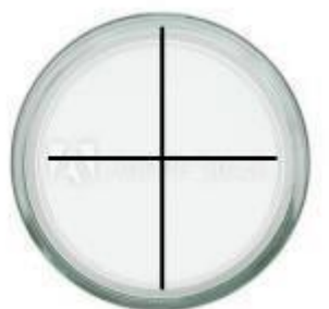
FIGURA 8 – Representação das tomadas das medidas do crescimento micelial do fungo nas placas de Petri. Fonte: Freepik, 2017.
