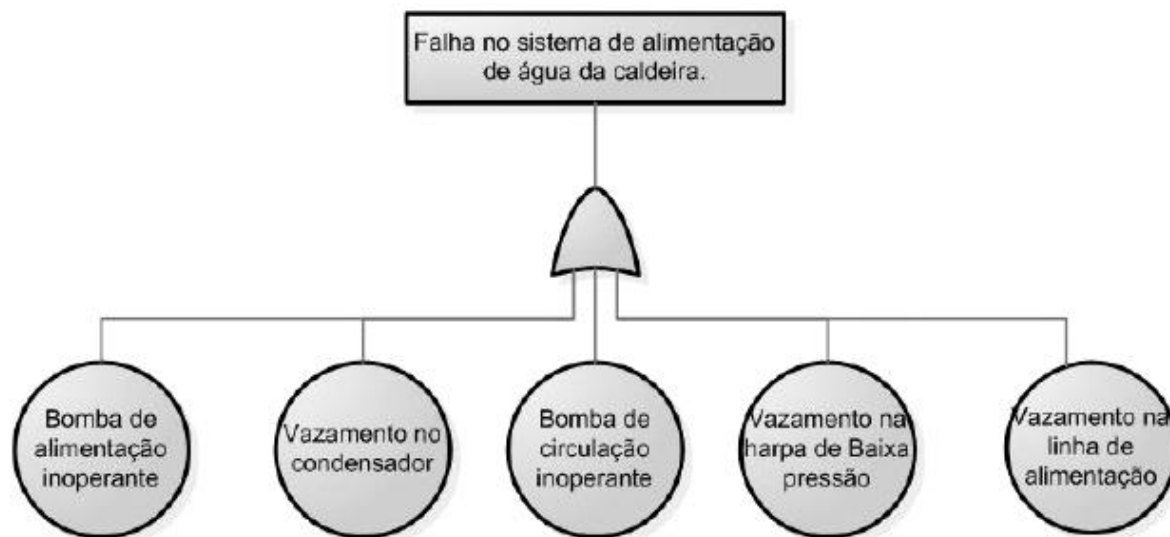
Figura 24 - Exemplo da estrutura de árvore de falhas
