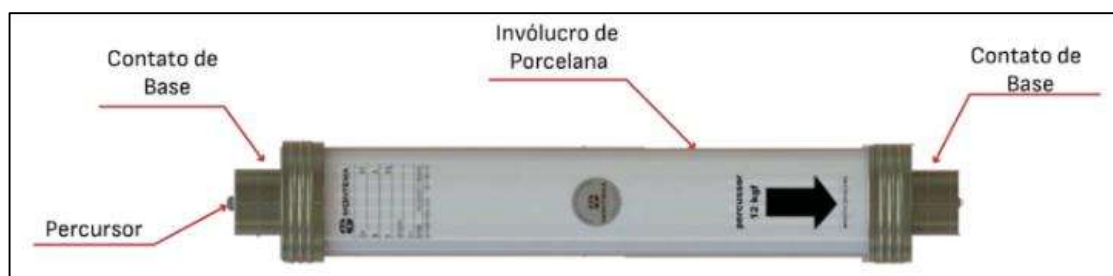
Figura 13 – Fusível tipo HH
