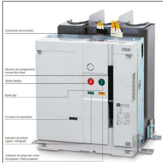
Figura 16 – Disjuntor de média tensão á vácuo
