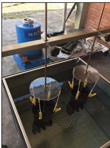
Figura 76 – Ensaio de luvas isolantes com o instrumento Hypot
