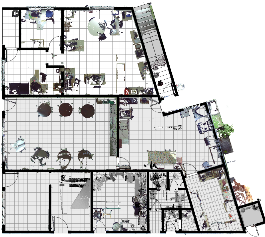
Figura 3 – Planta baixa feita sobre nuvem de pontos
