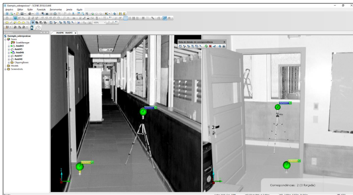
Figura 33 – Exibição de esferas com relação de correspondência
