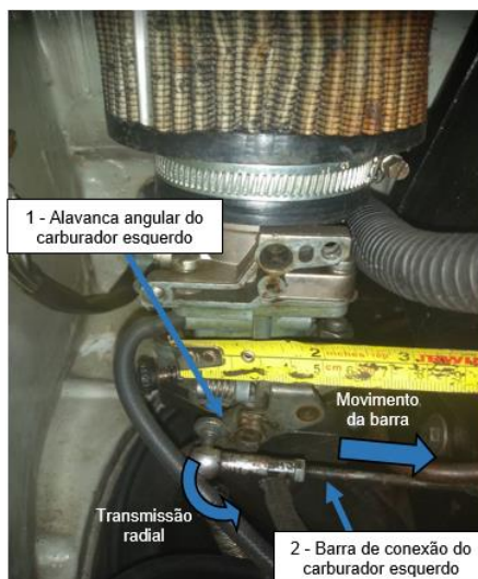
Figura 20 - Acionamento carburador modelo Solex 32
