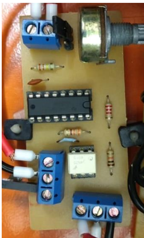
Figura 10 – Placa de tratamento de sinal.
