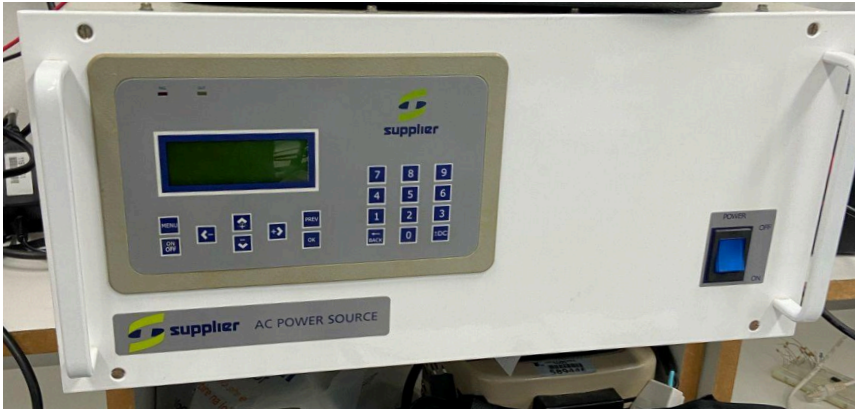
Figura 47 - Fonte utilizada em testes de bancada
