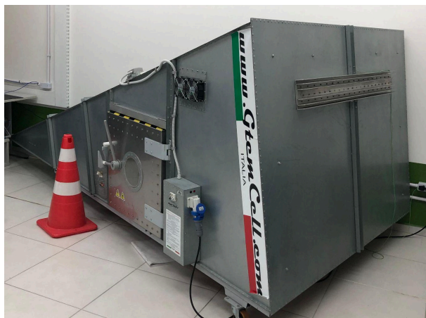
Figura 13 - Câmara Semi-Anecóica presente no LabCEM do IFSC Florianópolis
