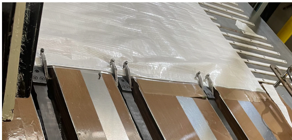
Figura 21 - Sistema de tração alternada por correias
