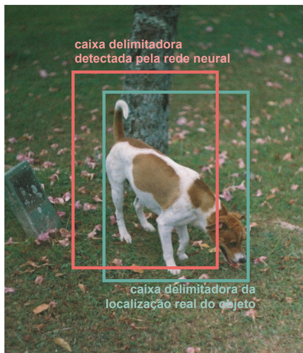
Figura 14 – Exemplo de caixa delimitadora prevista por uma rede neural em comparação com a localização real do objeto para o cálculo da IoU.
