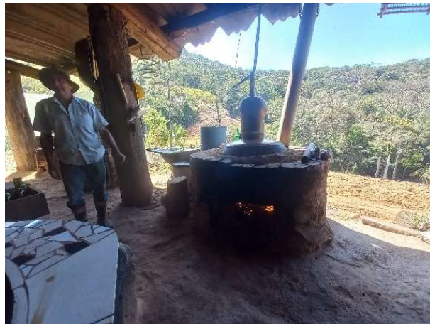
Figura 8 – Alambique, processo de destilação da bebida
