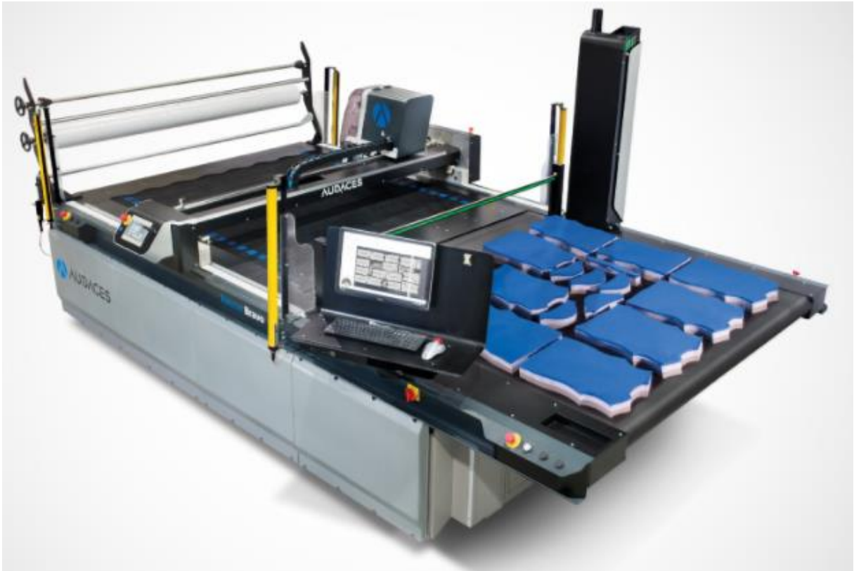
Figura 13 – Máquina de corte automatizada Neocut Bravo
