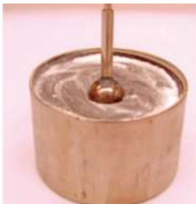
Figura 9 - Cuba e esfera do ensaio de resiliência dos ligantes modificados
