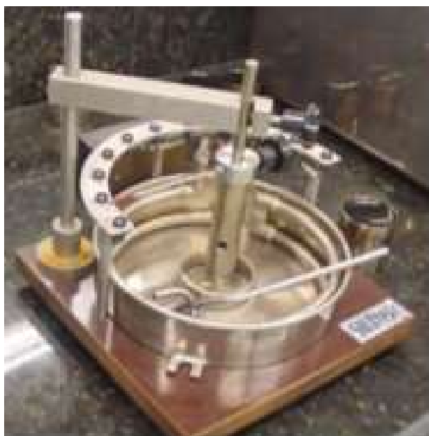
Figura 7 - Equipamento do ensaio de recuperação elástica por torção
