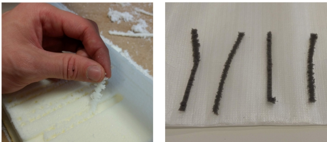
Figura 17 - Cavacos gerados no ensaio do parâmetro de avanço (Vf)
