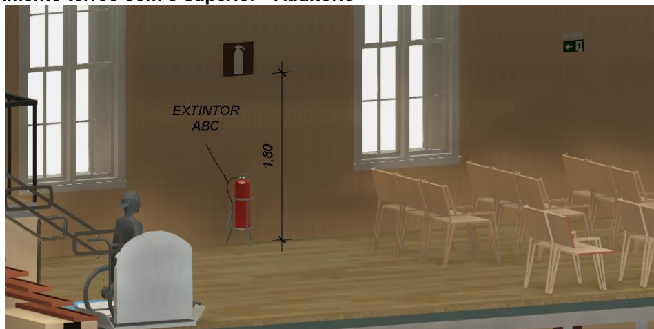
Figura 44 – Posicionamento do extintor de PQS BC, próximo a escada interna de madeira que liga o pavimento térreo com o superior - Auditório
