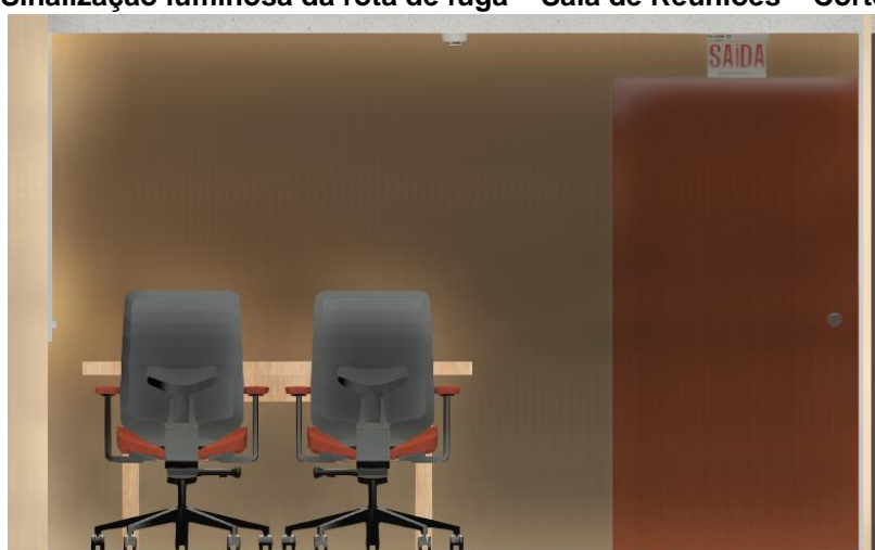
Figura 29 – Sinalização luminosa da rota de fuga – Sala de Reuniões – Corte Transversal
