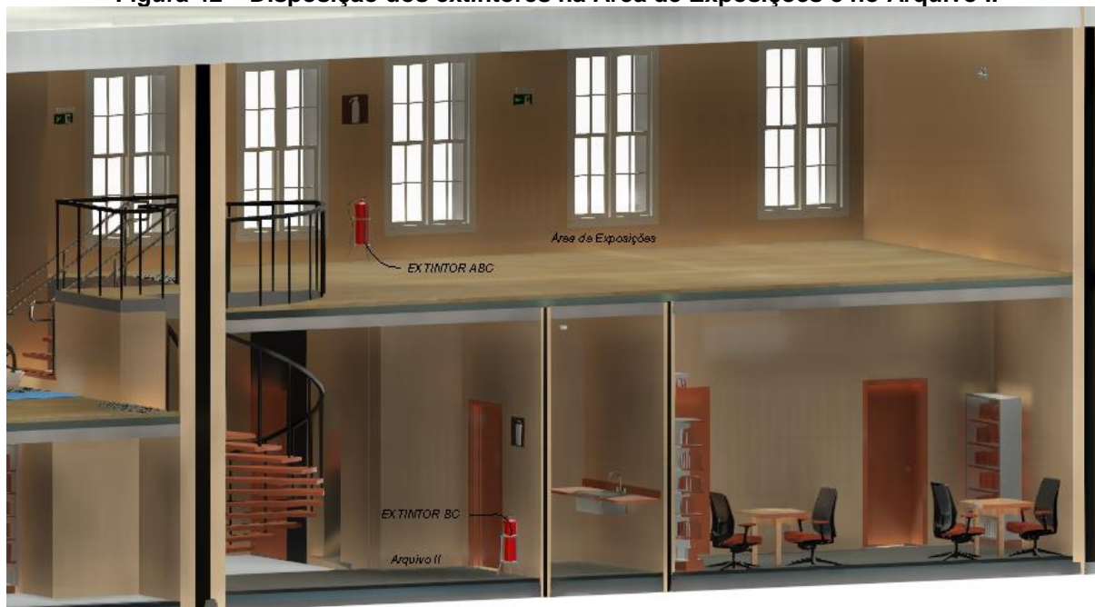
Figura 42 – Disposição dos extintores na Área de Exposições e no Arquivo II
