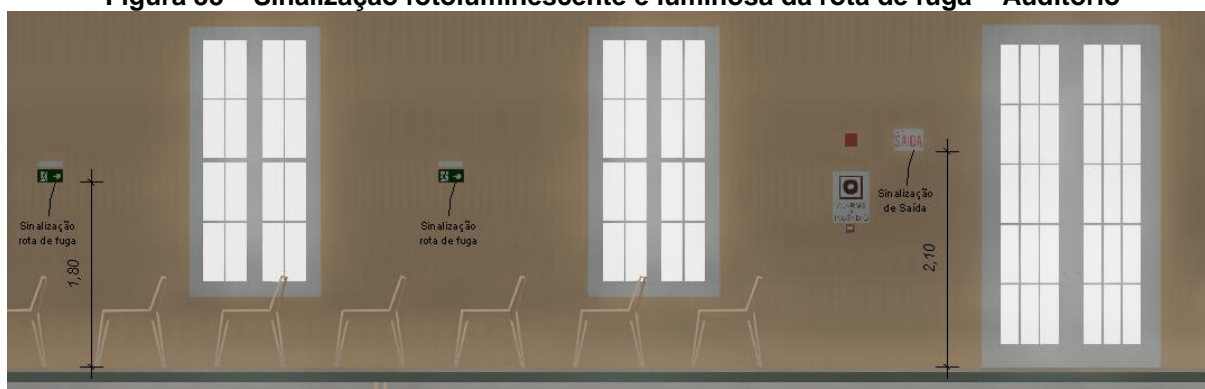
Figura 33 – Sinalização fotoluminescente e luminosa da rota de fuga – Auditório
