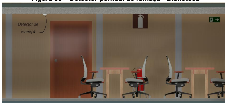
Figura 35 – Detector pontual de fumaça - Biblioteca
