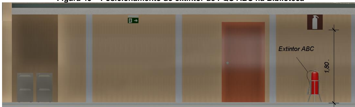
Figura 45 – Posicionamento do extintor de PQS ABC na Biblioteca
