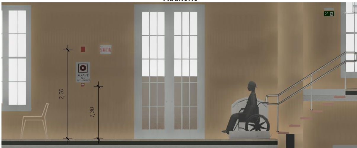
Figura 37 – Posicionamento do Acionador do Alarme de Incêndio e Sinalizador audiovisual - Auditório
