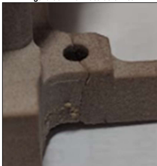
Figura 36 – Formato da trinca
