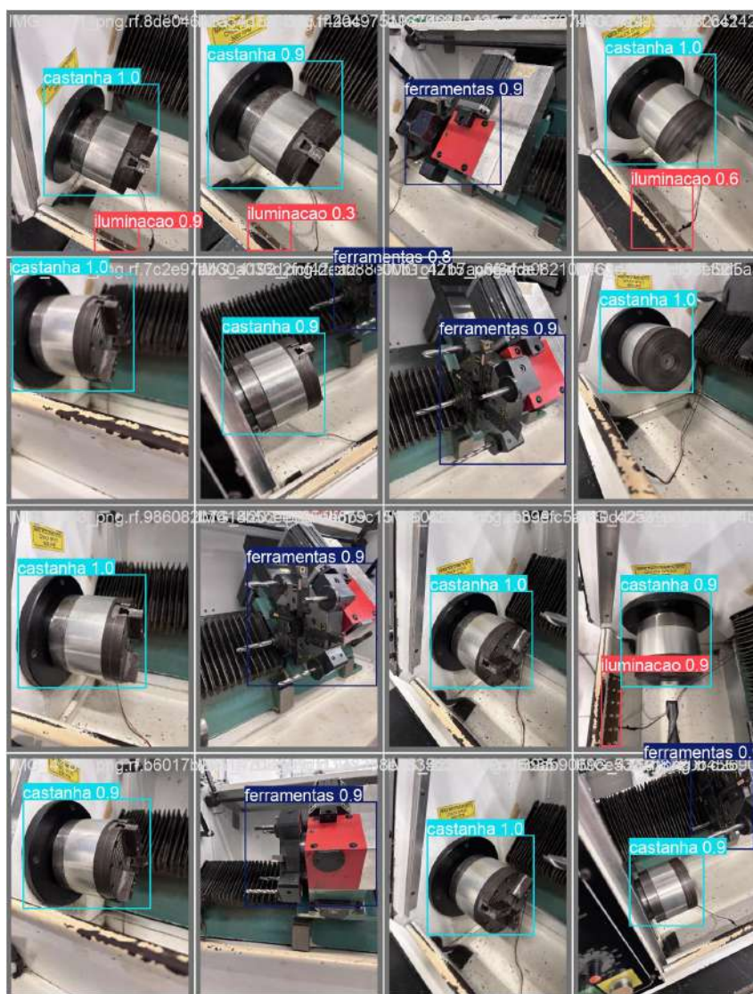
Figura 22 – Exemplos de imagens anotadas para treinamento do detector
