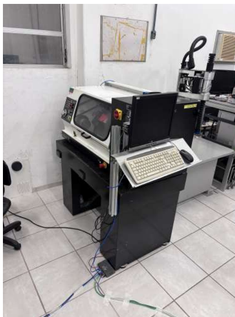
Figura 7 – Torno didático MIRAC-PC utilizado no desenvolvimento
