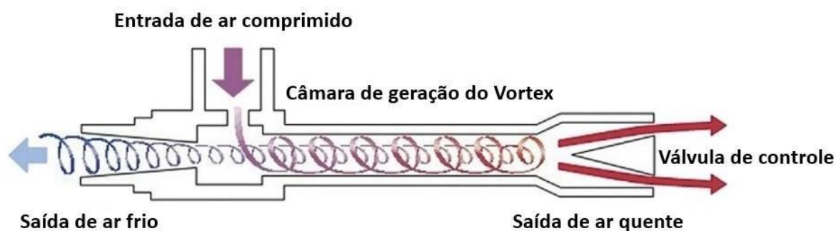
Figura 2 - Representação do funcionamento do sistema de resfriamento vortex de Ranque-Hilsch
