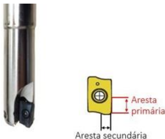
Figura 4 - Representação dos pontos de desgaste de aresta primária e secundário no inserto
