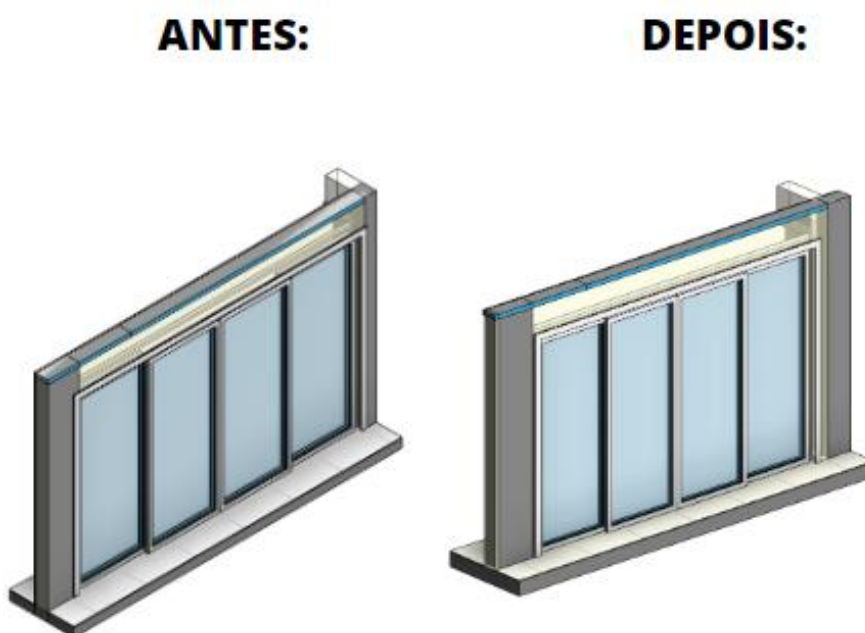
Figura 50 - Solução conflito porta-janela x pilar
