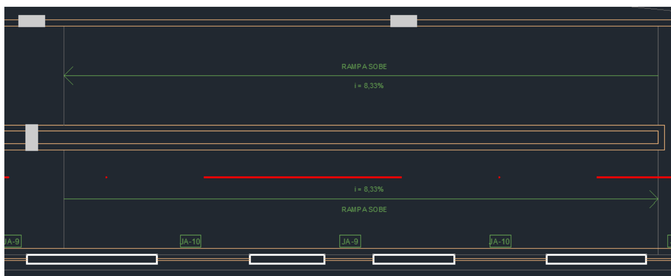
Figura 29 - Rampa de acesso para o segundo pavimento
