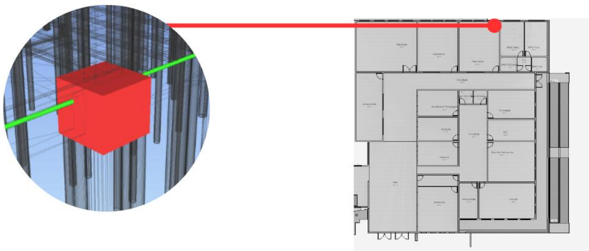
Figura 55 - Tubulação x Blocos de Fundação (Pavimento 1)
