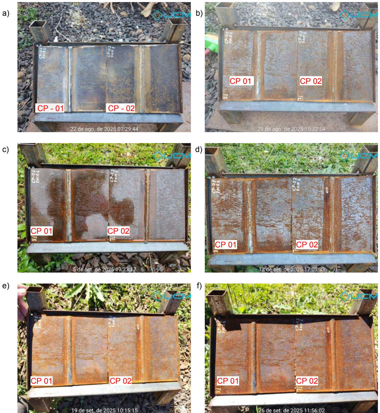
Figura 34 - Corpos de prova durante o ensaio de exposição atmosférica e as datas que foram registradas as imagens : a) 22 de Agosto; b) 29 de Agosto; c) 05 de Setembro; d) 12 de Setembro; e) 19 de Setembro; f) 26 de Setembro; g) 03 de outubro; h) 10 de Outubro.
