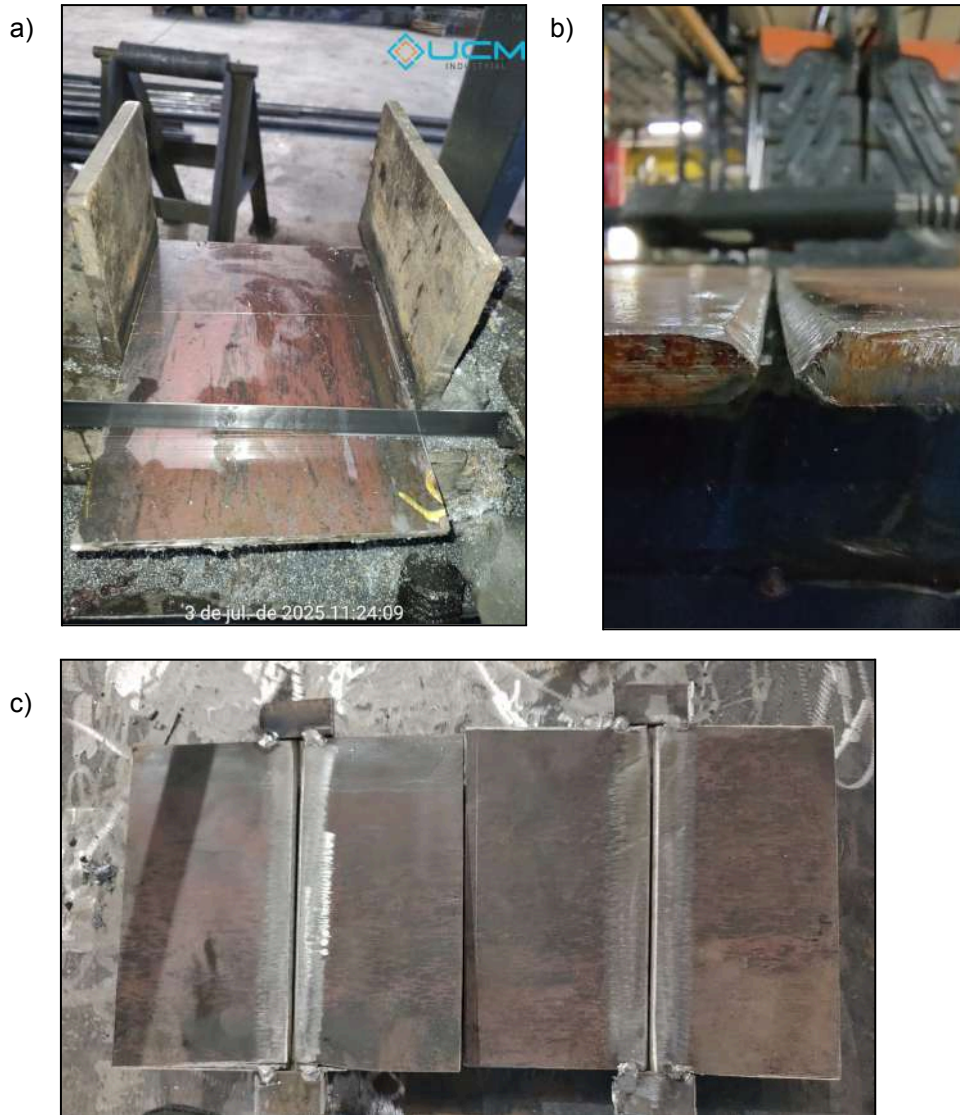
Figura 32: a) Corte dos CPs; b) Chanfro preparado para soldagem; c) CPs prontos para a soldagem.
