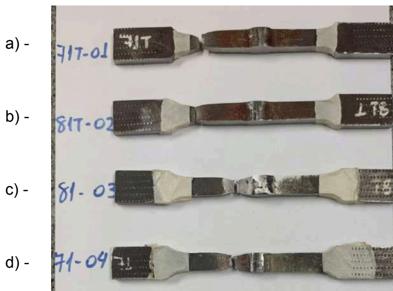
Figura 42 – Corpos de prova após o ensaio de tração : a) CP 01 - 71T1-1CM - exposto ao tempo; b) CP 02 - 81T1-W2C - exposto ao tempo; c) CP 03 - 71T1-1CM - sem exposição; d) CP 04 - 81T1-W2C - sem exposição
