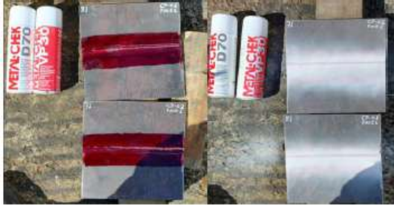
Figura 22 : Ensaio de líquido penetrante
