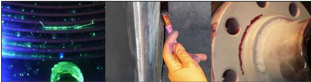
Figura 18 - Aplicação do LP do tipo fluorescente tipo 1 e visíveis tipo 2
