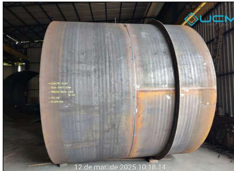
Figura 4 - Trecho reto fabricado em aço patinável
