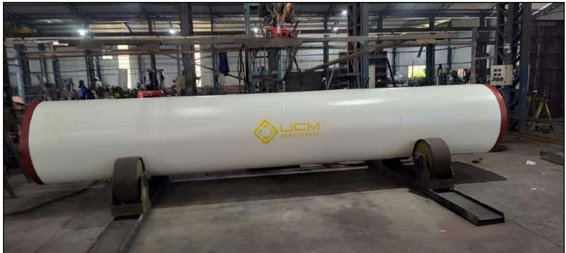
Figura 2 - Trecho reto do conduto forçado com pintura
