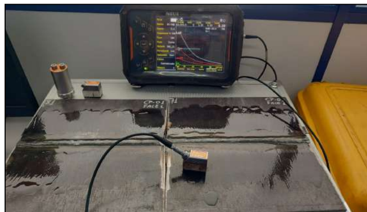
Figura 24 : Ensaio de ultrassom - transdutores angulares
