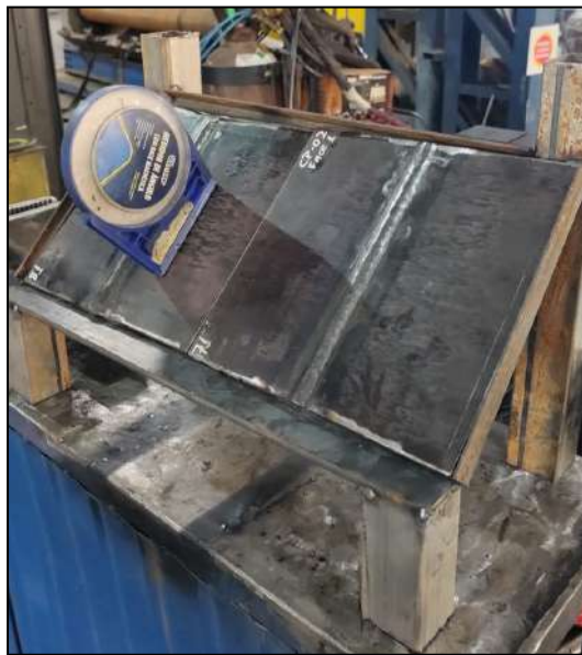
Figura 25 : Corpos de prova preparados a 30°
