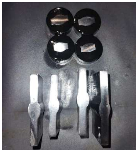
Figura 28 – Amostras lixadas e embutidas
