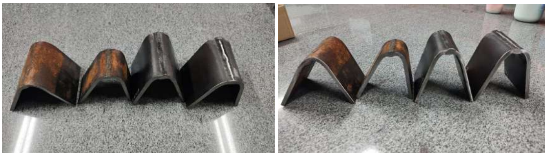
Figura 45 – Corpos de prova após o ensaio de dobramento
