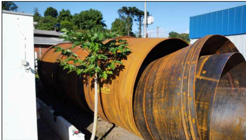
Figura 3 - Trechos retos fabricados em aço patinável
