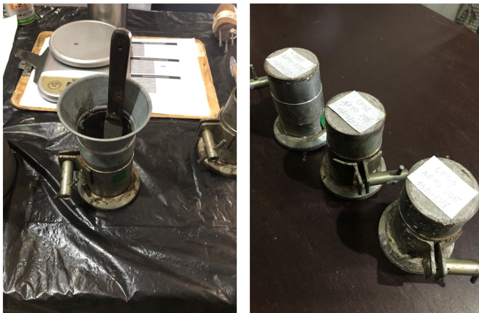
Figura 15 – Moldagem dos corpos de prova
